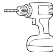
Taladro y broca de 1/8 in
